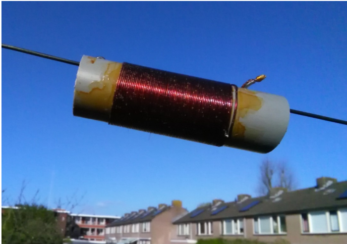
De spoelen gewikkeld en in de schellak gezet (had ik nog van de Paraset spoelen).
